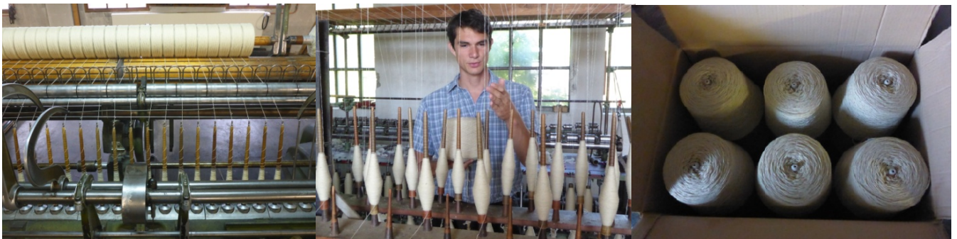
Die gesponnene Wolle ist in Spule auf Konen gerollt, die in der Zwirnerei abgerollt werden, um ein Garn mit drei Fäden zu zwirnen.
