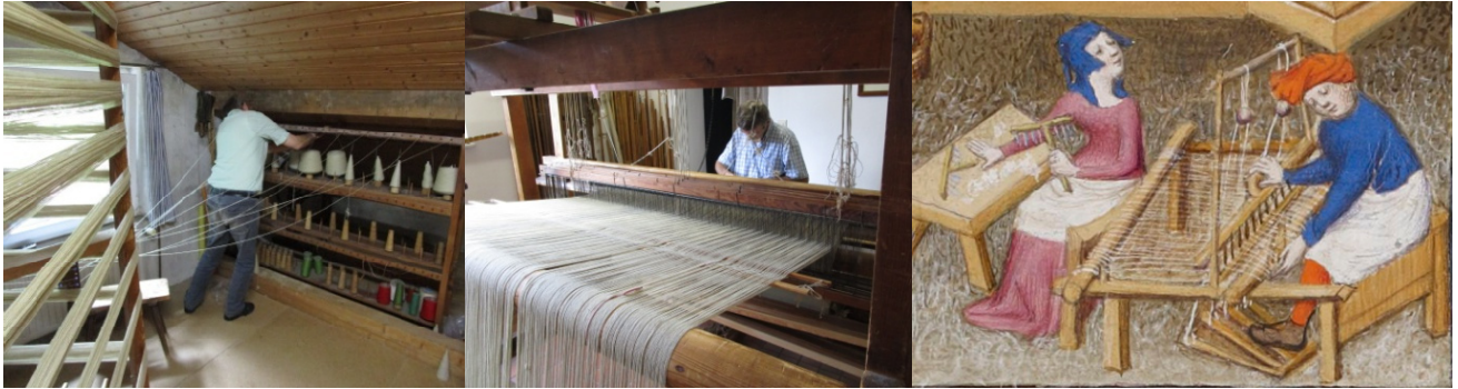
Messen der Kettenfäden unserer Wolle im bayerischen Wald und Handweben in Flandern (die Luftfeuchtigkeit ermöglichte, die Wolle mit Körperbindung zu weben).
