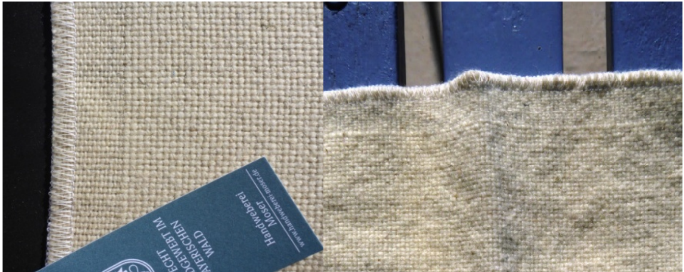
Die handgewebte Wolle Links: Erste Probe mit handgewebter Wolle (hier einfache Bindungen) und das Garn, gesponnen und drei Mal gezwirnt. Recht: Dasselbe Stück nach dem leichten Walken, für unsere erste Kollektion.
