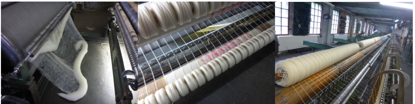
Am Ende der Krempel wird das Streichgarn (oder Vorgarn) in kleinen Streifen gerollt, schon vorbereitet für das Spinnen. Das Streichgarn ist in Streifen getrennt.
