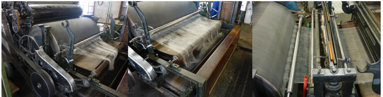
Nach dem Waschen werden die Wollfasern durch das Kardieren gleichmäßig verteilt durch drei Kardier-Maschinen (das Ganze wird auch Krempel genannt).
